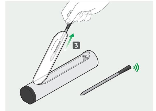
**4.** Öffne die Ladestation (3) und nimm den Sensor heraus. Wenn du den Sensor aus der Ladestation entnommen hast, blinkt die LED grün und zeigt an, dass der Sensor und die Ladestation miteinander verbunden sind.
